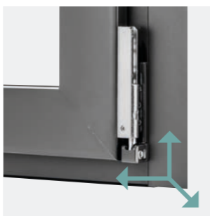
Réglage tri-dimensionnel du palier d'angle : réglage latéral, en hauteur et en compression
